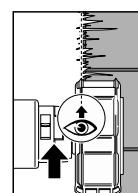
Pour aller pour le bord pelouse / trottoir meilleurs marqueurs sont montés sur le droit de protection réglable et à gauche, qui caractérisent la position du disque.
